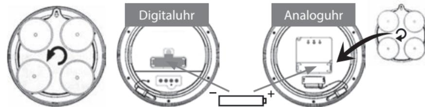
1. Drehen Sie die Gehäuseabdeckung ab und öffnen Sie das Batteriefach. Die Batterie ist bereits im Batteriefach eingelegt, jedoch ist der Kontakt mittels eines Batterieisolationstreifens unterbrochen. Entfernen Sie diesen Batterieisolationstreifen und achten Sie darauf, die Batterie (LR 6/R 6 AA 1,5 V) wieder polrichtig (-/+ ) einzulegen, da ein falsches Einlegen der Batterie zu einer Beschädigung der Funk-Baduhr führen kann. Schließen Sie nun die Batteriefachabdeckung.
